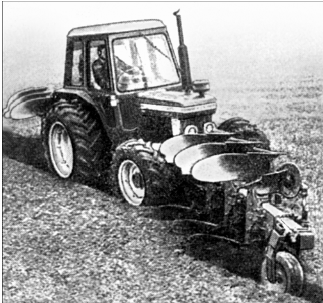
Рис. 13.6. Трактор, агрегатований із плугами на передній і задній навісках (за І.П. Ксеневичем та ін.)
