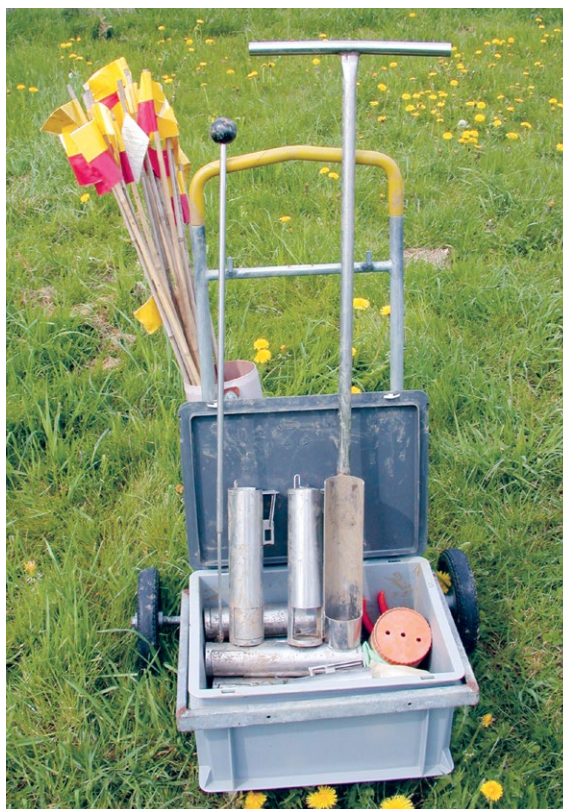
Обычный набор Torcat состоит из поискового зонда, резака для отверстий, маркировочных палочек и дюжины ловушек.
