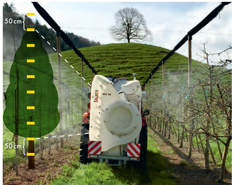
Хорошо отрегулированный опрыскиватель обеспечивает равномерное покрытие всей кроны дерева, от верхушки до нижних побегов, внутри дерева, а также на верхней и нижней части листьев.
