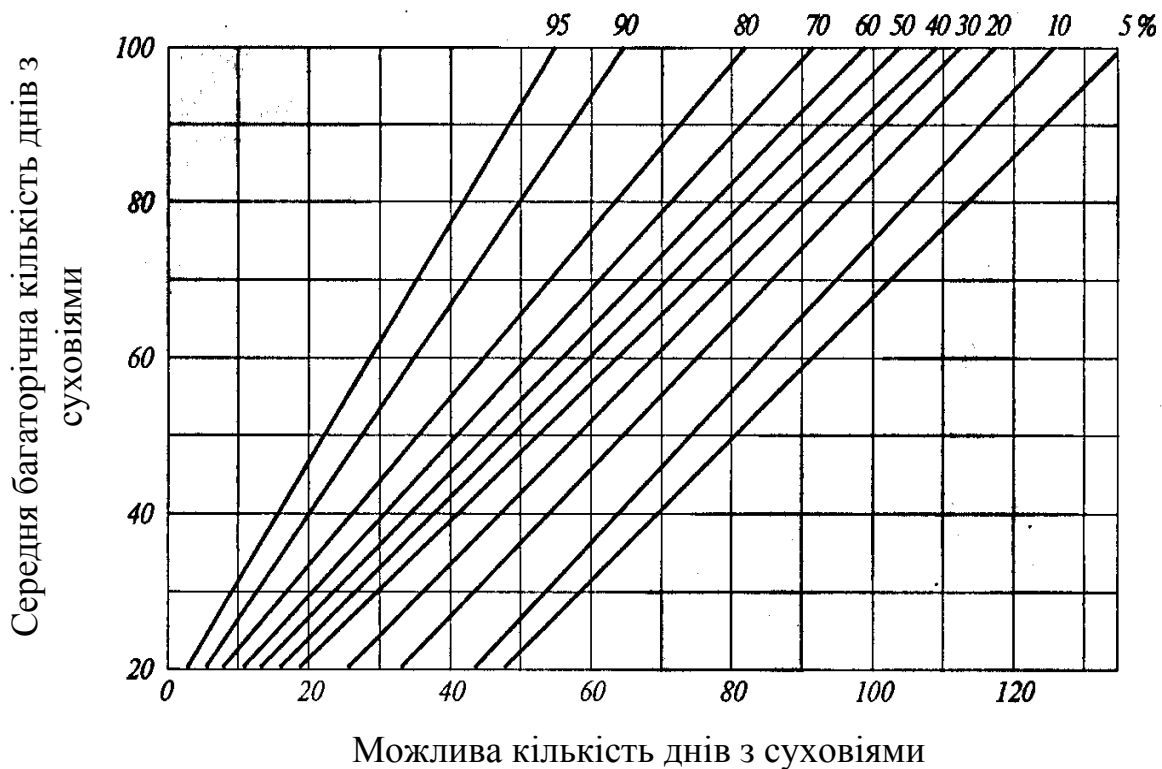
Рис. 8.1 – Номограма сумарної імовірності можливої кількості днів з суховіями в залежності від середньої багаторічної їх кількості за період квітень-вересень на ЄЧ СНД. (за В.О. Селяніновим і Л.Е. Пасечнюк)
