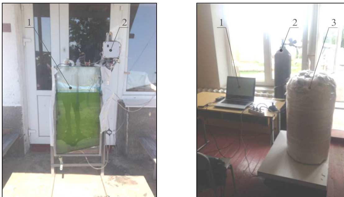
Рис. 1. Система культивування Ch. vulgaris : а) плоский вертикальний фотобіореактор (1а) із контрольно-вимірювальною системою (2а); б) вимірювальний сервер (1б), термоакумулятор (2б), вуглекислотний балон (3б)
