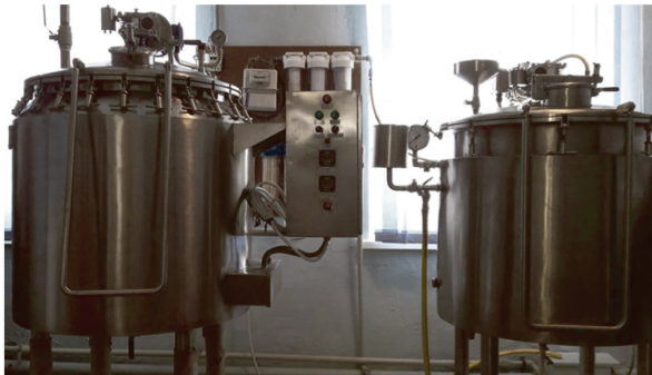
Рис. 1.10.5. Дослідно-промислова ферментаційна установка ДПФУ-330 на базі автономних біореакторів АФ-0,270 (зліва) та АФ-0,170 (справа)
