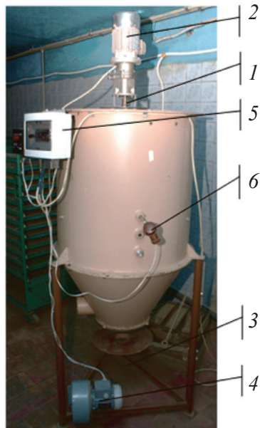
Рис. 1.6.3. Експериментальна установка для безкасетного розведення зернової молі: 1 – вертикальний шнек; 2 – мотор-редуктор з електричним приводом; 3 – приймальний сажок; 4 – вентилятор; 5 – пульт керування; 6 – терморегулятор з термодатчиком
