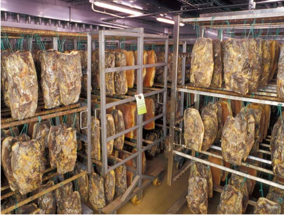
Ілюстрація 8. Камера для дозрівання шинки з сушінням на відкритому повітрі. Контрольований мікроклімат та належна гігієна є важливими параметрами виробництва сиров'яленої продукції без додавання нітритно-сольової суміші Фото: www.oekolandbau.de/CopyrightBLE/DominicMenzler .
