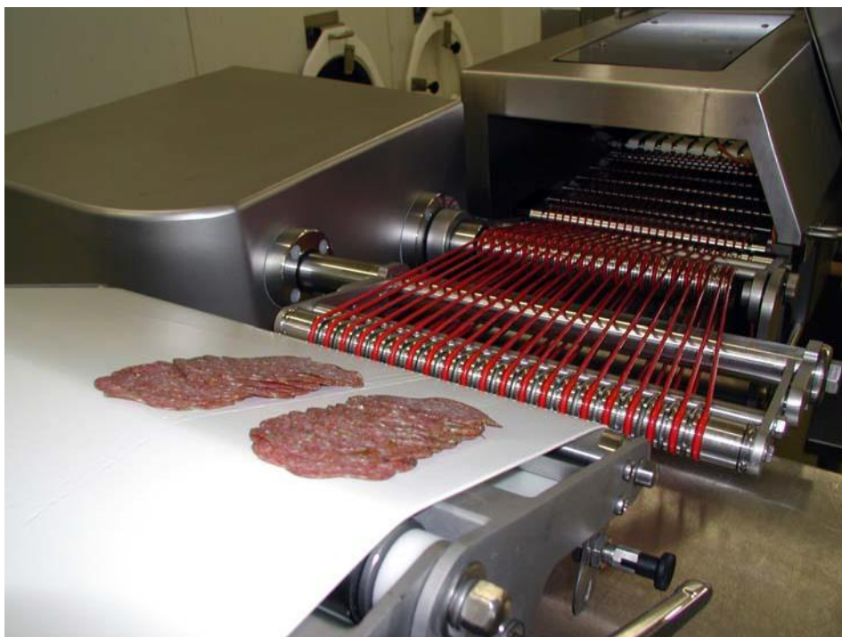
Ілюстрація 13. Слайсер для нарізки ковбасних виробів, що упаковуються в індивідуальну упаковку самообслуговування. Передумовою виробництва такої нарізаної продукції з тривалими мінімальними строками придатності є максимальний рівень гігієни. Фото: Chiemgauer Naturfleisch GmbH.
