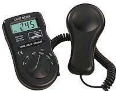
Ілюстрація 15. Люксметр для вимірювання рівня освітленості. Фото: Conrad Electronic SE.
