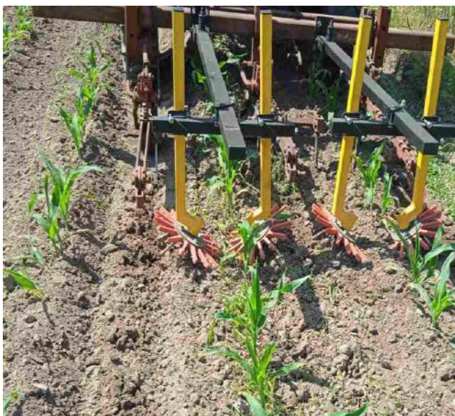
Рис. 2. Робота культиватора з пальцево-зірчастими дисками в рядках кукурудзи
