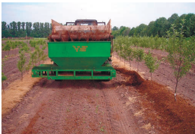
Рис. 4.17. Внесення мульчматеріалів за допомогою розкидача органічних добрив РОУ-6 в стрічці ряду молодих насаджень яблуні
