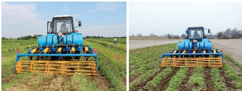
Фото 2. Глубокорыхлитель «ГЧ4», оборудованный системой подачи ЖГУ.
