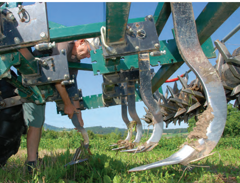
В тяжелой, уплотненной почве можно взрыхлить подпочву, используя культиватор для глубокого разрыхления. Для стабилизации рыхлого состояния необходимо затем посеять культуры для зелёного удобрения или культуры с длинными корнями.
