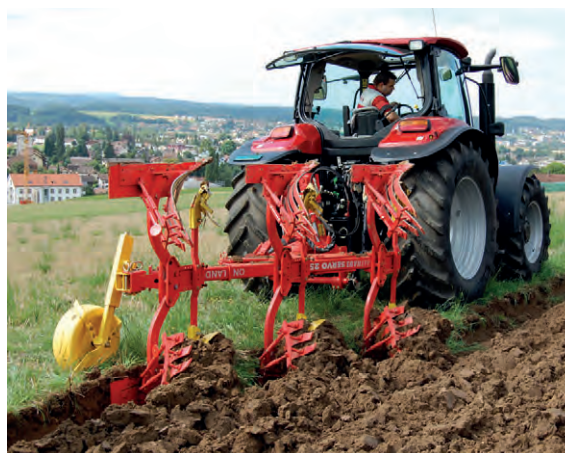
Используя специальный полунавесной оборотный плуг (on-land), можно выйти за рамки борозды. Этим предотвращается уплотнение подпочвы, скольжение и образование плужной подошвы.
