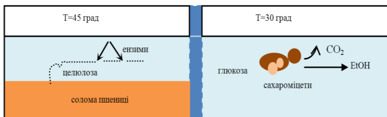
Рис. 1. Принципова схема роботи двокамерного біореактора
