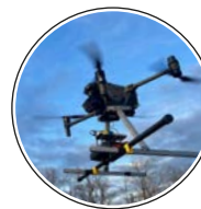
Технологія від UADamage До сенсорів підключений ШІ, що прискорює ідентифікацію мін, снарядів та уламків.
